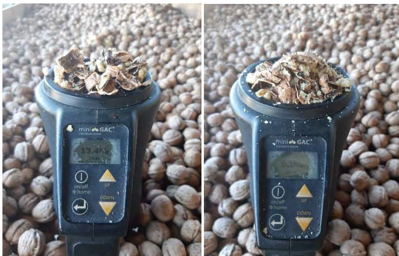
Figura 4. Medición del porcentaje de humedad de la nuez, izquierda nueces con 13,4%, mientras que las nueces de la derecha presentan 9,1%.
