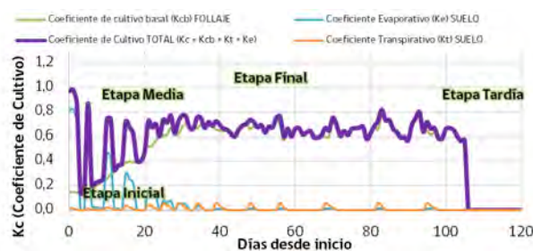
Figura 1. Evolución del ciclo de crecimiento del zapallo italiano entre febrero y mayo; localidad de Pan de Azúcar. Basado en índice NDVI satelital ( K_c = K_{cb} + K_e + K_s ).
