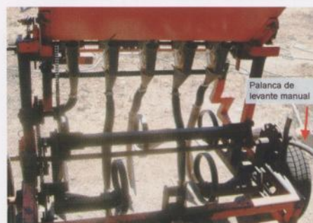
Figura 3. Posición de la palanca de levante manual en la sembradora.
