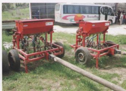
Figura 2. Sistema de enganche del pértigo en la sembradora para conseguir la horizontalidad de trabajo de la máquina.
