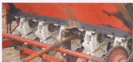
Figura 4. Sistema de dosificación de la semilla mediante rodillo acanalado.
