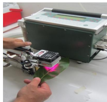
El equipo Li-cor 6400 realiza las mediciones de transpiración, fotosíntesis y conductancia estomática.
