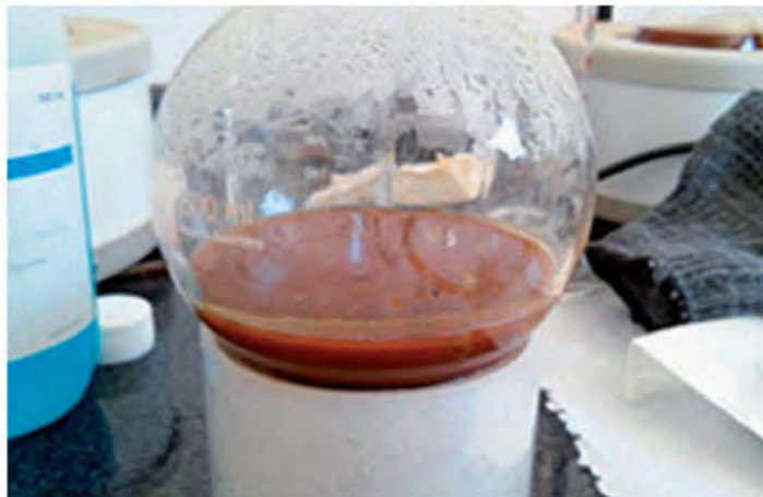
Fotografía 2: Análisis para determinar azúcares reductores presentes en la salmuera, el color rojo de la imagen es debido a la reducción del ion \text{Cu}^{2+} de color azul a \text{Cu}^{+} .
