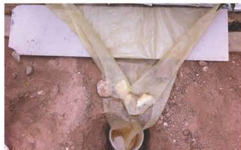
Figura 2: Detalle de la lámina para recibir y conducir el agua de drenaje y el recipiente de acumulación.
