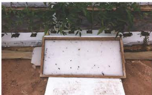
Figura 1: Sistema para recibir y medir el agua drenada por una unidad de sustrato, cubierta para protegerla de la radiación solar y la generación de algas.
