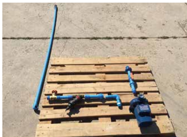
Figura 5. Elementos utilizados para el armado del cabezal de riego del módulo FVH.
