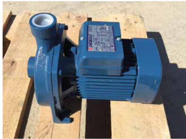
Figura 2. Motobomba utilizada, y con la cual se hicieron los cálculos de consumo eléctrico.
