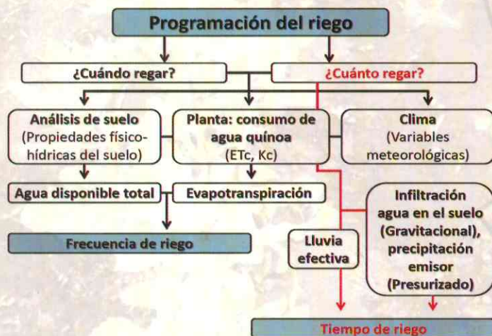
Figura 1. Diagrama general de una programación de riego en el cultivo de quínoa, de acuerdo a la relación de suelo-planta-clima.
