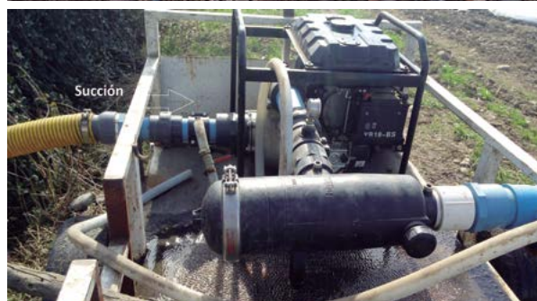
Foto 4. Motobombas utilizadas para la succión de agua.
