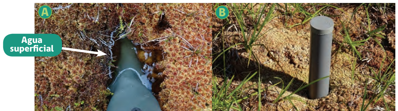
Figura 2. A) Cubierta continua de musgo Sphagnum y el nivel freático superficial de la turbera y B) Piezómetro instalado en una turbera de Sphagnum , para medir el nivel freático.
