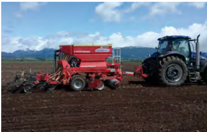
Figura 5. Maquinaria de mínima labranza. Preparación de suelo, compactación, siembra y compactación final (trabajo en tandem).
