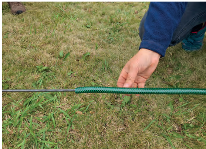
Figura 3. Fierro de construcción forrado con manguera.
