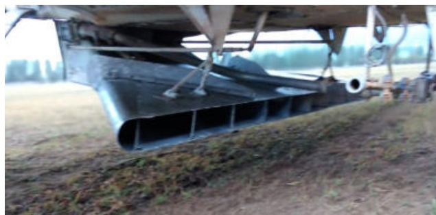
Figura 3. Tobera de salida de la mezcla fertilizante ubicada en la parte baja del avión.
