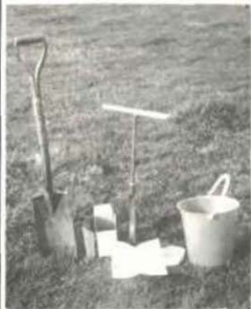
Implementos necesarios para el "Muestreo" de suelos. Pala o barreno, cuchillo, balde, envase con hoja de antecedentes.
