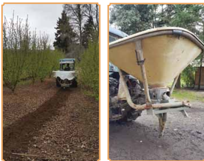
Foto 4. Máquina para incorporar fertilizante fosfatado a lo largo y costado de la hilera de plantación, gentileza de Alberto Stepke. Comuna de Villarrica, Región de La Araucanía.
