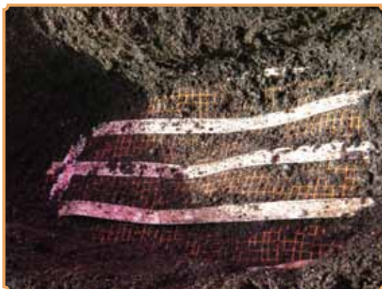
Foto 4. Temperatura basal mediante resistencia eléctrica.
