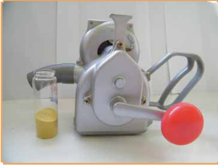
Foto 8. Máquina manual para asperjar formulados sólidos en base a polen.
