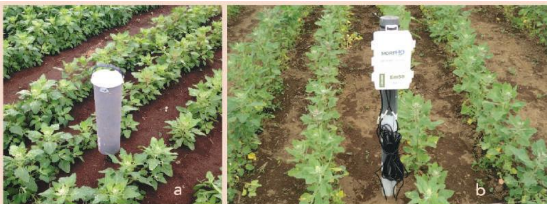
Foto 3. Sensores de humedad de suelo instalados en los ensayos de riego. a) Tranapunte, b) INIA Carillanca. Fuente: Rafael López-Olivari (INIA Carillanca)
