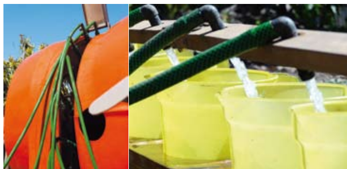
Figura 7: Determinación del caudal de las boquillas en un pulverizador hidroneumático.
