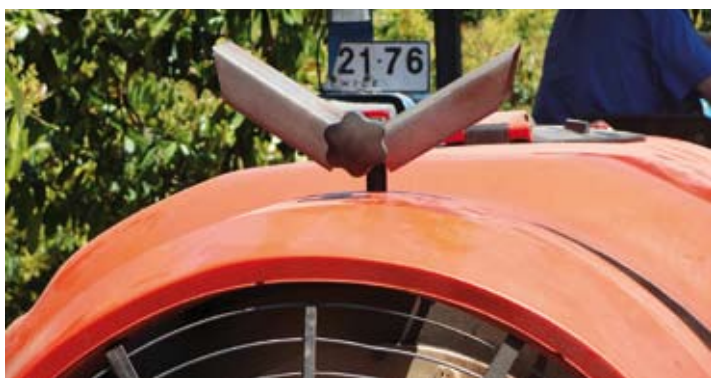
Figura 4: Deflectores superiores de viento.
