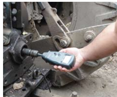
Figura 1: Medición de las revoluciones al eje del toma de fuerza.
