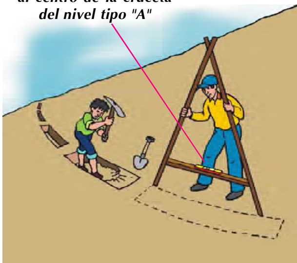
Figura 1. Trazando la línea sin caída para la zanja de infiltración.
