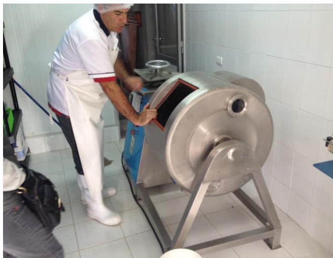
Foto 2. Boleadora para elaboración de mantequilla de bajo volumen.
