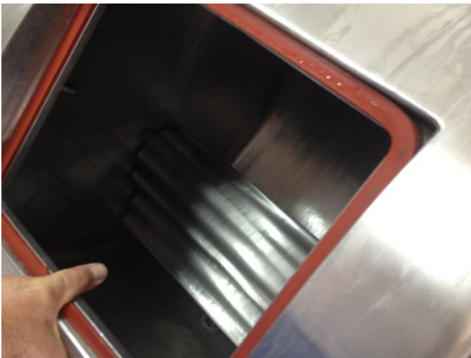
Foto 4. Rodillos para amasado de mantequilla
