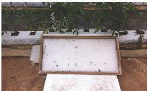
Figura 1: Sistema para recibir y medir el agua drenada por una unidad de sustrato, cubierta para protegerla de la radiación solar y la generación de algas.
