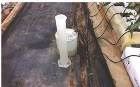
Figura 3: Unidad para recibir y medir el agua aplicada. Consta de 4 emisores idénticos a los que aplican el riego a las bolsas con sustrato.
