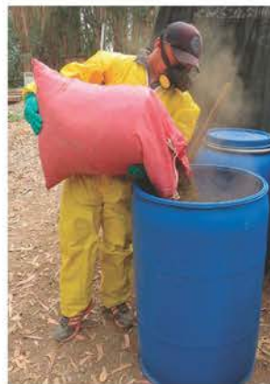
Figura 4: Equipo de seguridad del operador y aplicación de guano seco a la solución de hidróxido de potasio.
