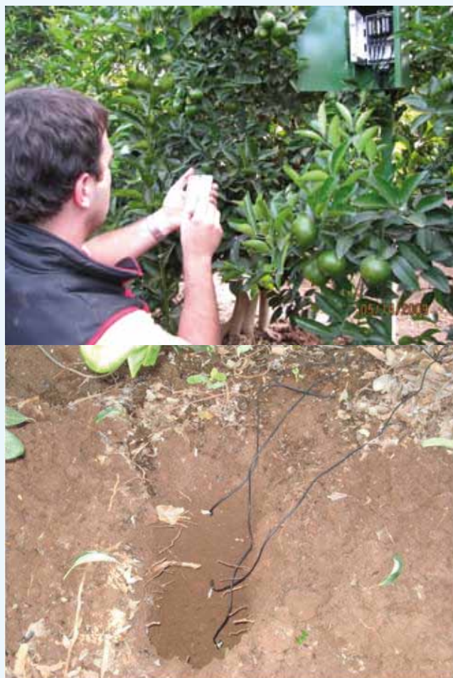
Foto 4. Sensores FDR de medición de humedad de suelo continua.
