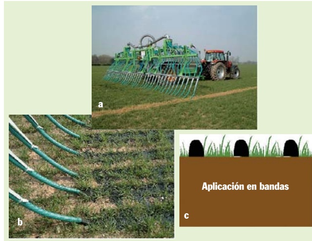
Equipo de inyección de purines al suelo: a) vista general; b) detalle de los tubos de aplicación y c) representación esquemática de la distribución del purín sobre el suelo (IGER, 2000).
