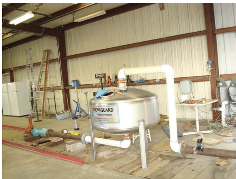
Banco de Prueba para evaluar filtros de cuarzo.
