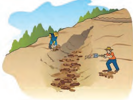
Figura 2. Procesos de eliminación del suelo de los bordes de la cárcava.
