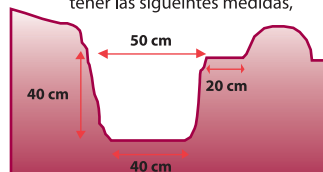
Figura 2. Construcción de zanjas
