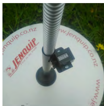
Figura 3. Plato de aluminio y registro de alturas comprimidas, que va acumulando las lecturas realizadas en cada punto.
