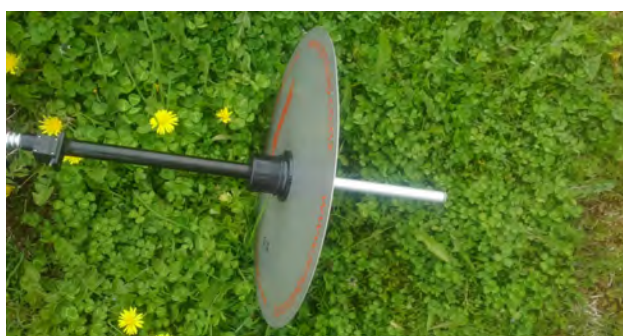
Figura 1. Vista lateral del plato. Se observa el vástago central y a la derecha el extremo que toma contacto con el suelo.
