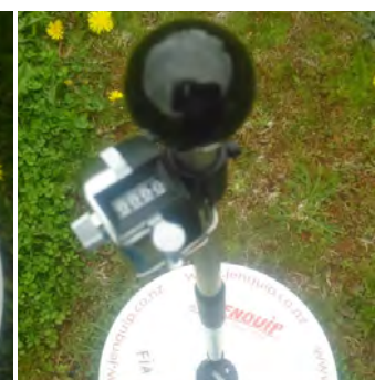
Figura 4. Registro contador de lecturas adosado al bastón o vástago. Permite contabilizar las lecturas.
