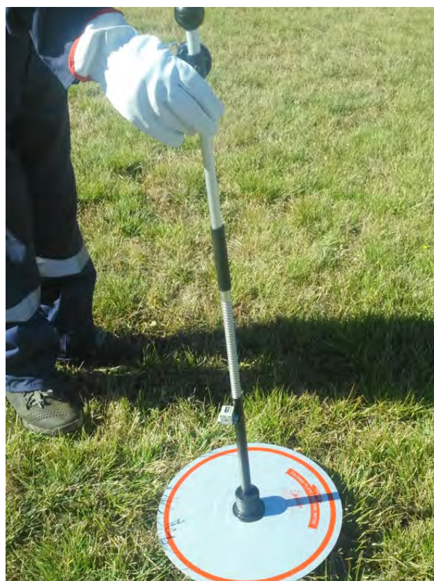
Figura 2. Plato medidor de disponibilidad de materia seca en praderas a pastoreo.
