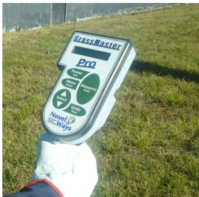
Figura 2. Microprocesador del capacitómetro donde se ingresa la ecuación de calibración y obtienen las lecturas de disponibilidad de materia seca en kg MS/ha.
