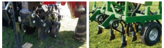
Figura 5: Máquina de cero labranza de discos (derecha) y zapata (izquierda).
