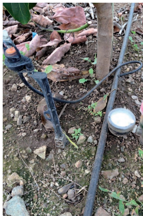
Foto 4. Monitoreo de riego mediante uso de tensiómetros.
