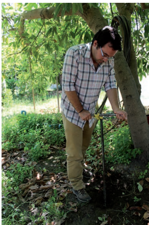
Foto 2. Con el barreno se debe tomar muestras de suelo a distintas profundidades y sectores del huerto.
