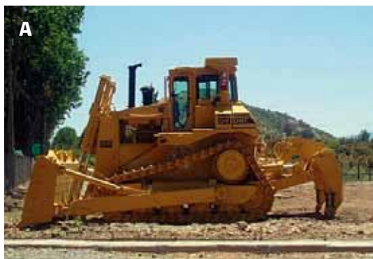
Foto 3. A. Tractor oruga D9 y B. Punta de subsolador.
