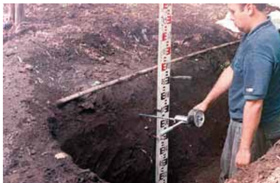
Foto 2. Medición de la resistencia mecánica con penetrómetro.
