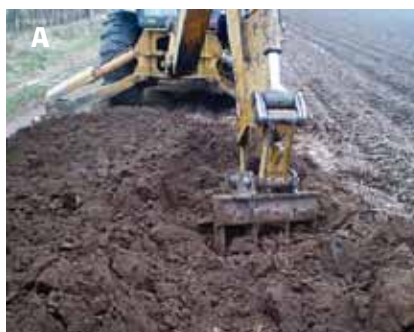
Foto 4. A. Retroexcavadora utilizada para subsolado. y B. El capacho original ha sido reemplazado por garras con punta.
