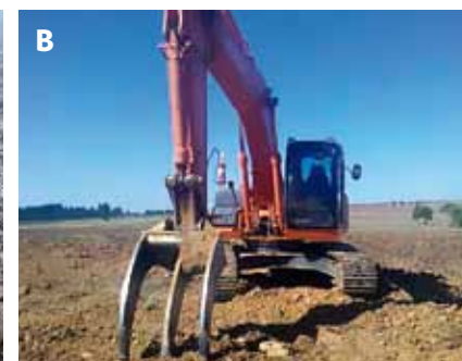
Foto 4. A. Retroexcavadora utilizada para subsolado. y B. El capacho original ha sido reemplazado por garras con punta.
