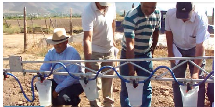
Foto 1. Medición del caudal de las boquillas a la presión que habitualmente trabaja.
