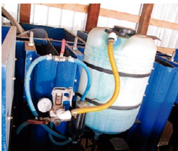
Foto 5. Sistema para desinfección de semilla o surco.
