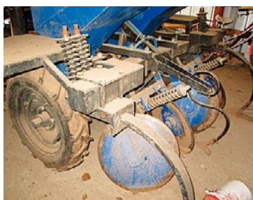
Foto 2. Sistema para tapado de surcos sembrados.
