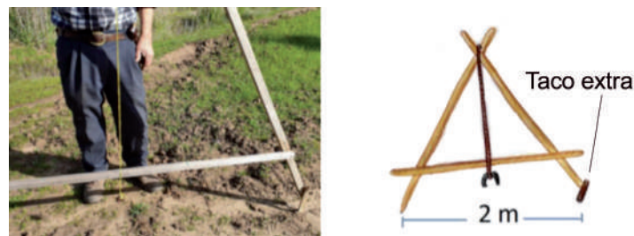
Figura 4. Nivel en A con taco extra en una de sus patas, para trazar una curva de escurrimiento.
