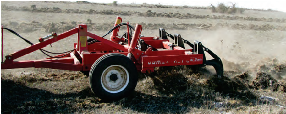
Figura 5. Arado subsolador escarificador de 5 puntas; equipo recomendado para labores de preparación de suelos primaria en el cultivo de la quínoa.
