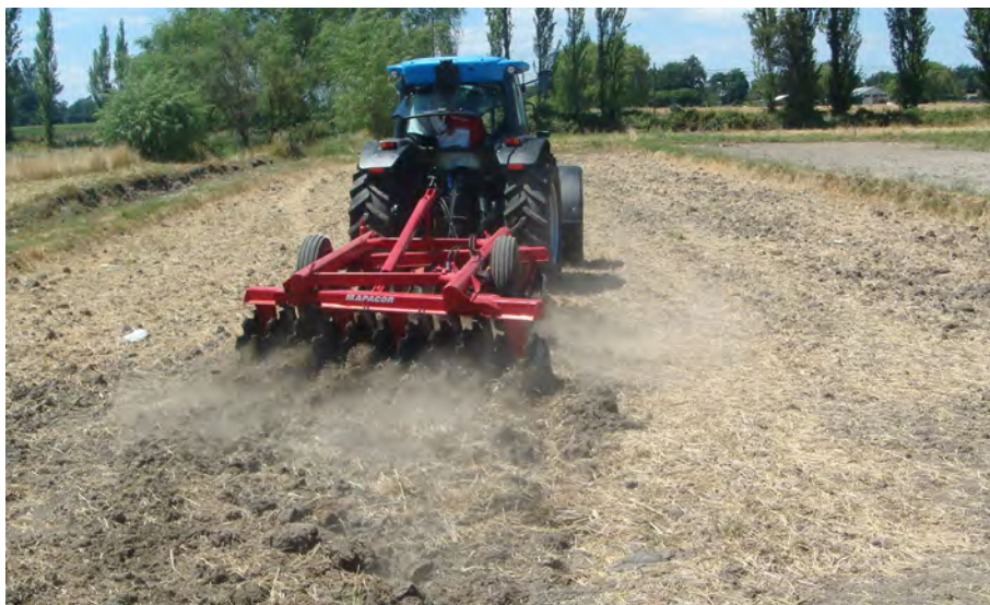
Figura 6. Rastra de discos, equipo ampliamente utilizado para labores secundarias.
