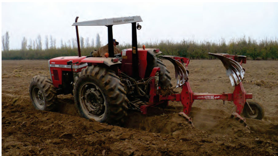
Figura 1. Arado de vertedera; equipo de labranza adecuado para la incorporación de rastrojos de cultivos.
