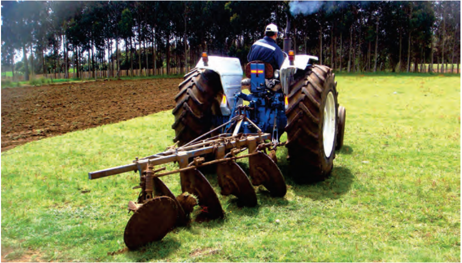
Figura 3. Arado de discos, implemento de labranza primaria para la inversión de suelos.
