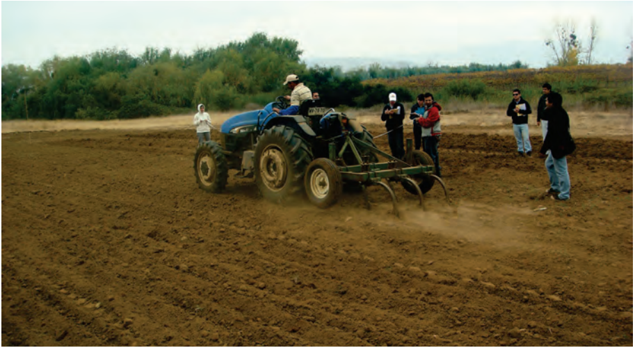
Figura 4. Arado cincel, equipo que rompe y suelta el suelo sin invertirlo ni mezclarlo.
