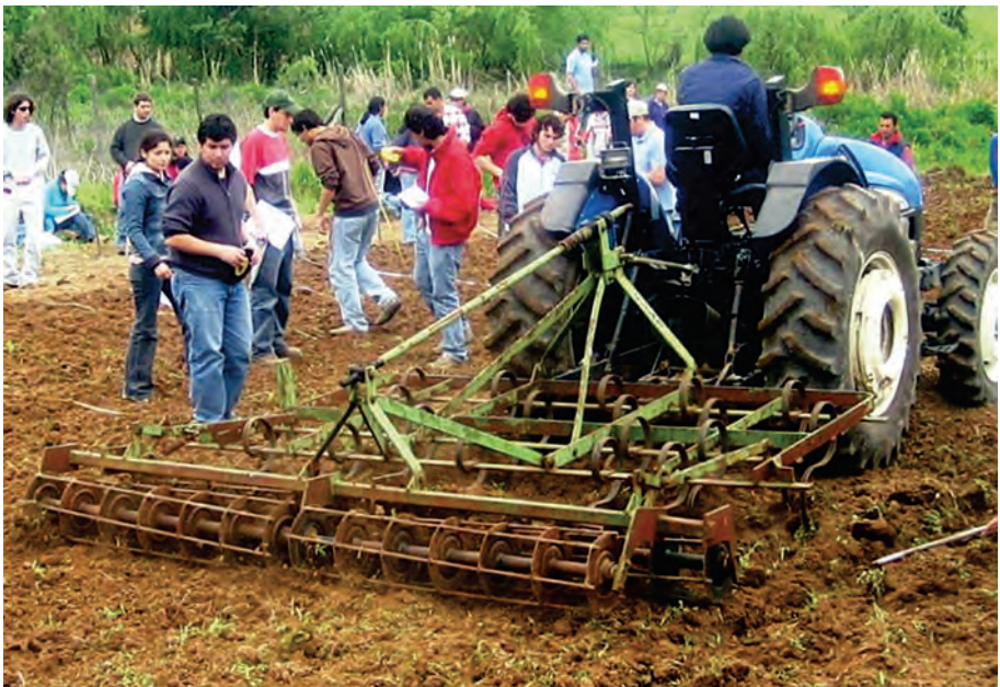
Figura 7. Vibrocultivador. Equipo adecuado para una labor de preparación de suelos secundaria.
