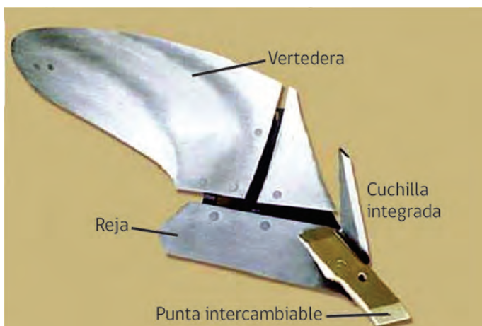
Figura 2. Elementos del arado de vertedera (Ministerio de Medio Ambiente y Medio Rural y Marino, España, 2008).
