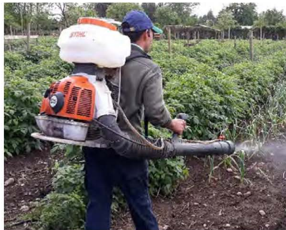
Foto 2. Pulverizador neumático de mochila, conocido comúnmente como "motopulverizadora".
