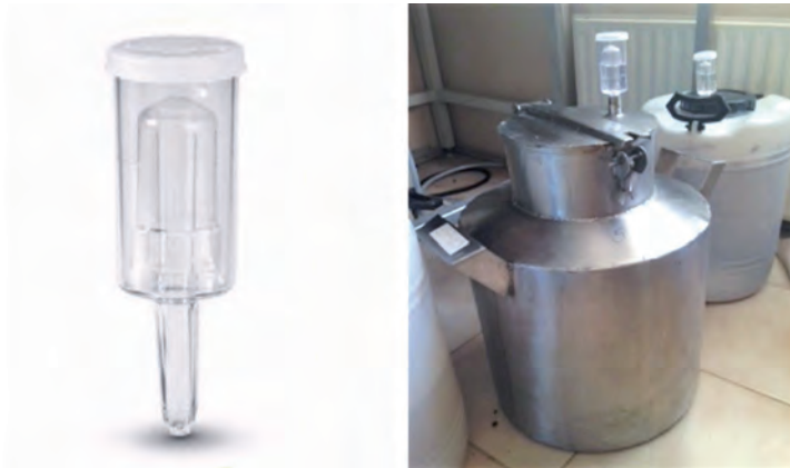
Foto 3.5. Barboteador instalado en estanque de acero inoxidable para micro vinificación.
