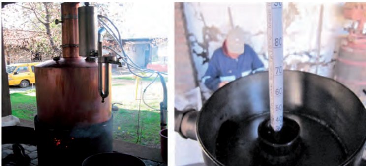
Foto 3.6. Destilador de cobre para elaboración de agua ardiente.
