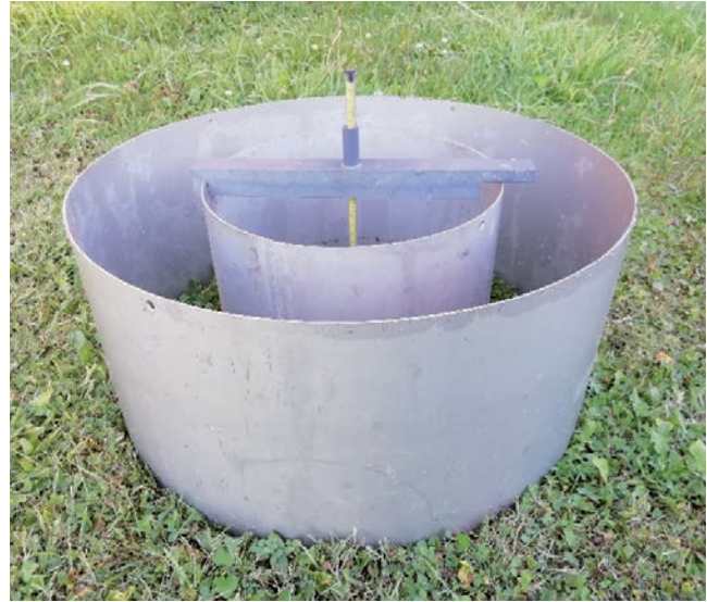
Figura 3: Infiltrómetro de doble anillo.
