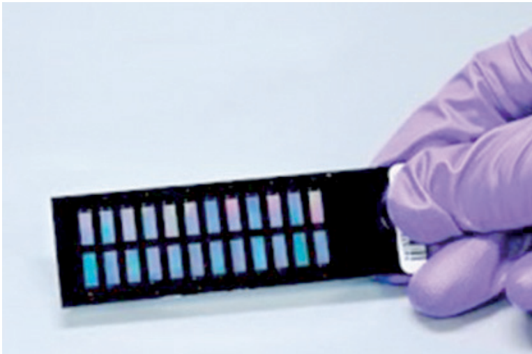
Figura 4.4. Chip (panel) para el análisis de marcadores genéticos tipo SNP (Fuente: Google sites; https://sites.google.com/a/irri.org/snp-genotyping-mmml/services/infinium-6k ).
