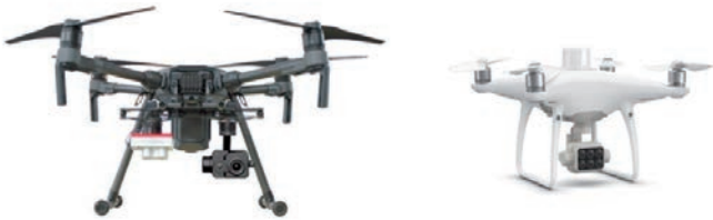
Figura 2. Dron con cámaras intercambiables (izquierda) y dron con cámara integrada (derecha).
