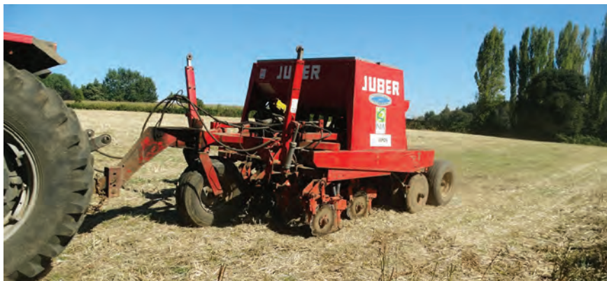
Figura 4.2. Sembradora equipada con disco turbo frontal para sembrar sobre rastrojos.
