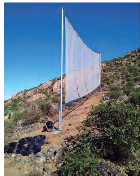
Figura 2. Estructura atrapanieblas instalada en cerro Perales de Taltal.
