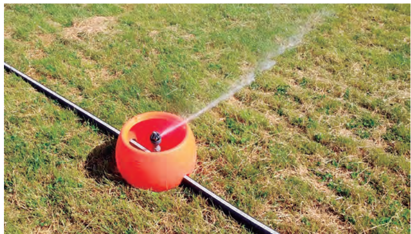
Figura 4. Sistema k-line, de origen neozelandés, que permite regar superficies relativamente pequeñas y a un bajo costo de inversión. Es un sistema móvil, que se adapta incluso a condiciones de pastoreo.
