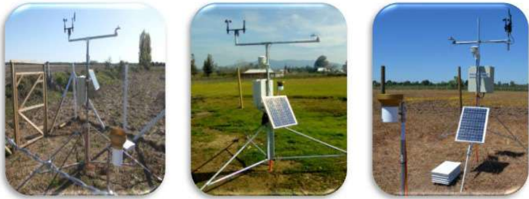
Foto 1. Estaciones meteorológicas automáticas instaladas en el área arrocerá: Miraflores en Longavi (35°49'3,64" S; 71°46'30,27" O), Monte Flor-Tucapel en Parral (36°14'41,68" S; 71°56'3,06" O) y en el Campo Experimental de Arroz de INIA, en San Carlos (36°24'30,15" S; 72°0'24,47" O). INIA-Tucapel S.A.-Carozzi S.A.
