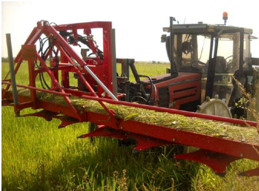
Foto 1. Barra de corte producida por un fabricante italiano, trabajando en un campo de arroz para eliminar los órganos reproductores de las malezas más altas que el arroz (en particular, el arroz malezas y Echinochloa spp.) Desde https://www.meneguzzo.eu/ .
