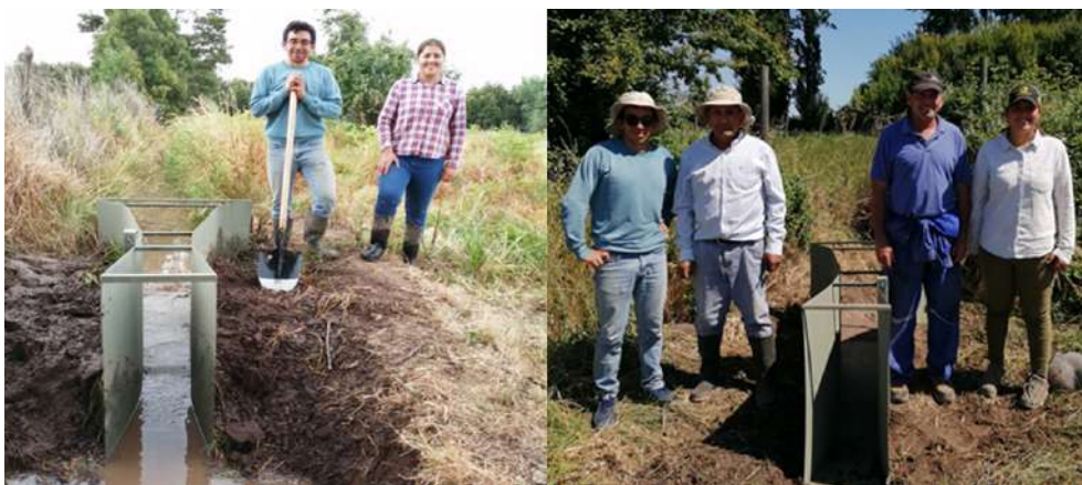
Foto 1. Aforador Parshall en campo de agricultor arrocero de la zona de San Carlos, 2020.
