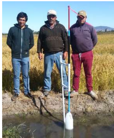
Foto 3. Medidor de nivel de agua en condiciones de campo.
