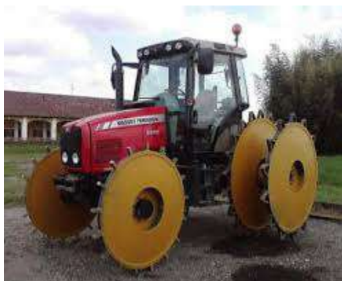
Foto 6. Tractor con rueda de lenteja para aplicaciones de herbicidas en arroz.
