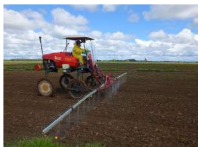
Foto 7. Tractor de ruedas altas con pulverizadora aplicando herbicida.
