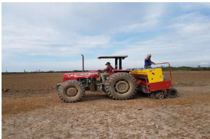
Foto 5. Máquina sembradora en líneas, accionada por tractor para ejecutar la siembra directa de arroz.
